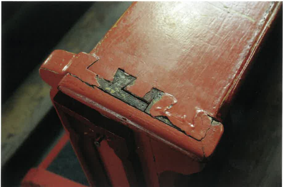
Fot. 17. Fragment podłokietnika z widocznym odspojeniem warstwy malarskiej w miejscu połączenia policzka z podłokietnikiem oraz destabilizacją złącza płetwowego półkrytego.
